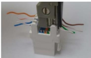
Закрепите каждую пару проводов на месте с помощью инструмента 110 или Krone.
